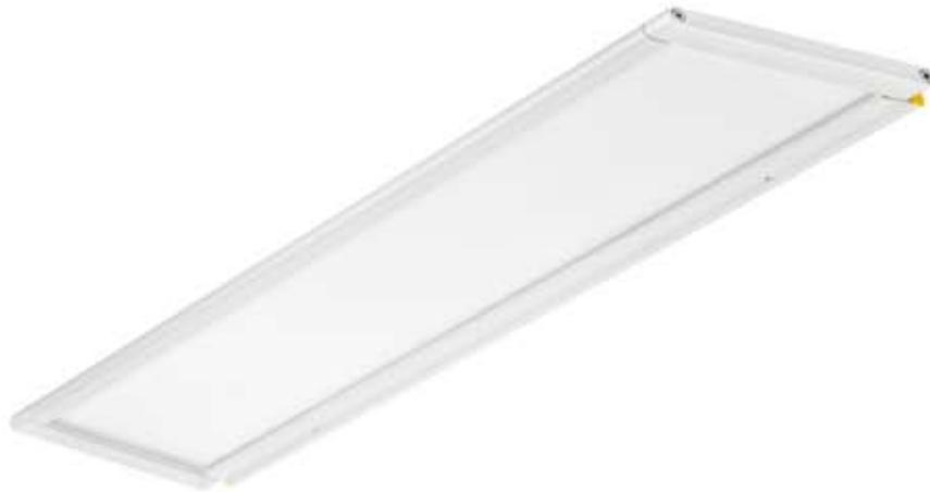
Die LED-Leuchte PL150 ist eine Hochleistungs-LED-Leuchte in einem extrem flachen Gehäuse. Durch eine spezielle verwendete Prismentechnik erzeugt diese LED-Leuchte kein punktuell-, sondern blendfreies, flächiges Licht wodurch die Leuchtdichte reduziert wird und mehrfache Schattenbildung auf der Arbeitsfläche verhindert wird. Für die PL150 wird ein 48V-Netzteil benötigt.
